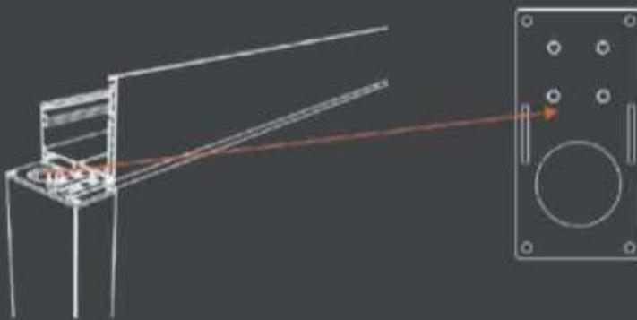
Canal de desagüe - unión de pata
