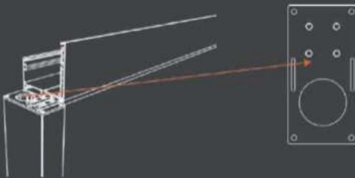
■ Canal de desagüe - unión de pata
